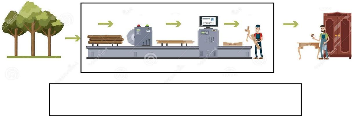
Una vez los árboles se han extraído del monte (tala) se eliminan sus ramas dejando el tronco liso y uniforme (poda). Se lleva los troncos a su lugar de destino donde serán o almacenados (transporte) o serrados y se utiliza maquinaria especializada para alisarlos (descortezado, troncado, secado, etc)
