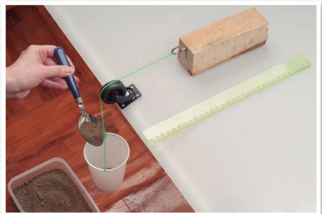
Añadan (de a poco) arena al vaso hasta que el bloque comience a deslizarse. Luego, midan y registren el desplazamiento y determinen la masa del vaso con arena.
