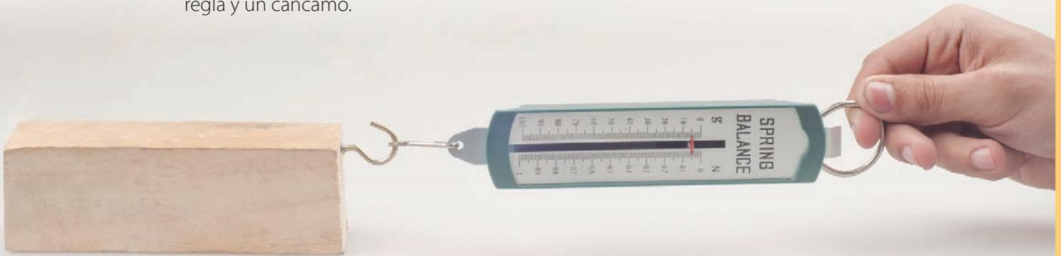
↑ Tiren del trozo hasta que este se ponga en movimiento. Una vez que el bloque se deslice, observen y registren la fuerza medida por el dinamómetro.
