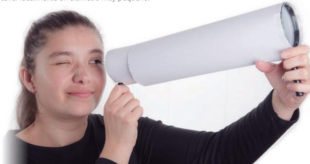
Inserten un tubo dentro de otro y enfoquen algún objeto distante, ajustando la distancia entre las lupas.
