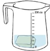
El **volumen** lo puedes medir mediante el desplazamiento de agua.
