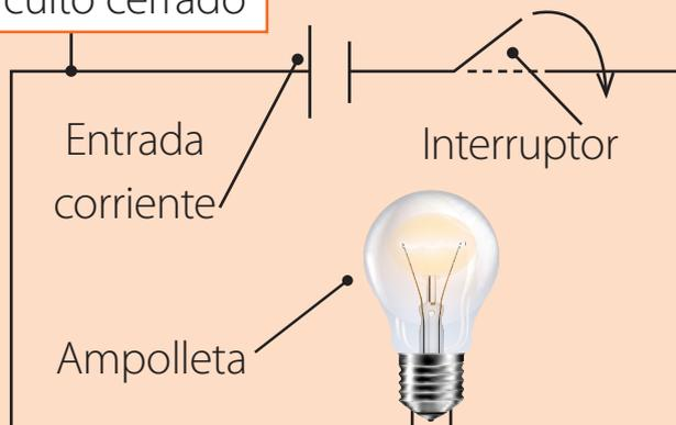
El interruptor corta o permite el flujo de la corriente por el circuito, lo que apaga o enciende la luz de la ampolleta.
